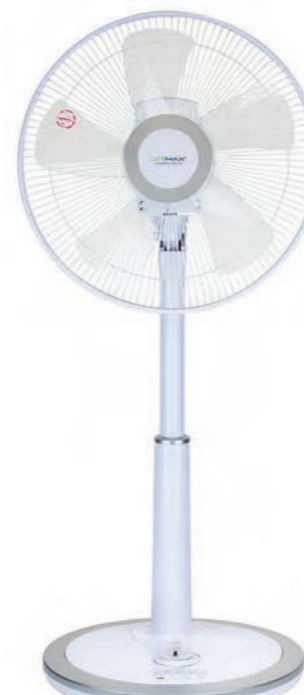
33 14" 좌석용 기계식 선풍기 UMF-7409XN ·저소음 설계, 5엽 날개 ·본체 분리 조립형 ·좌/우 회전 조절 ·조립이 간편한 자동망 테두리 ·최대 120분 타이머 예약기능 ·3단(강풍/약풍/미풍) 풍속 조절 ·220V/60Hz, 50W ·포장 : 1PCS/CTN
